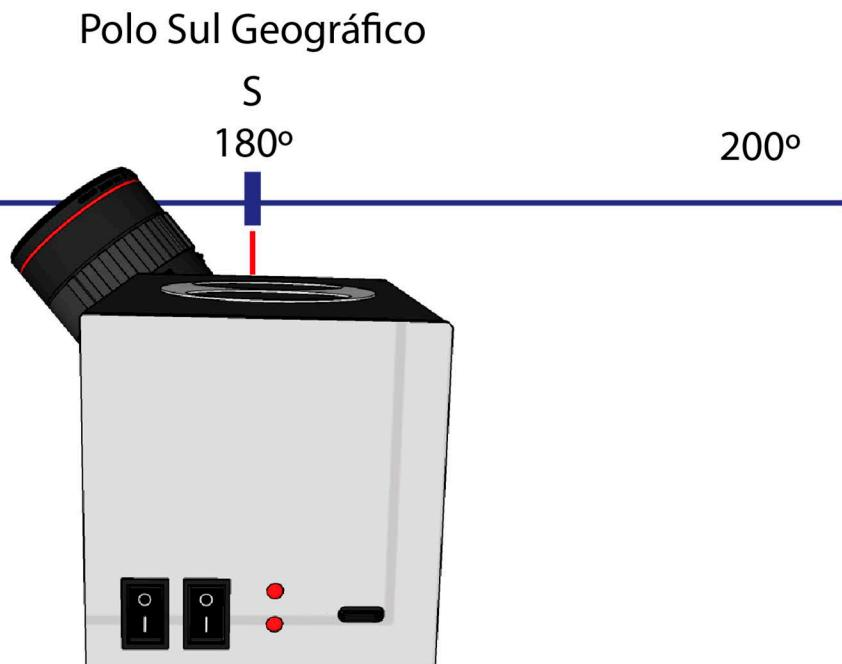
2 - Trave o movimento horizontal do seu tripé, assim ele ficará sempre apontado para a direção Sul. Depois, incline o tracker para o ângulo da sua latitude. Assim, o eixo do tracker estará alinhado com o eixo de rotação da Terra visto da sua cidade.
